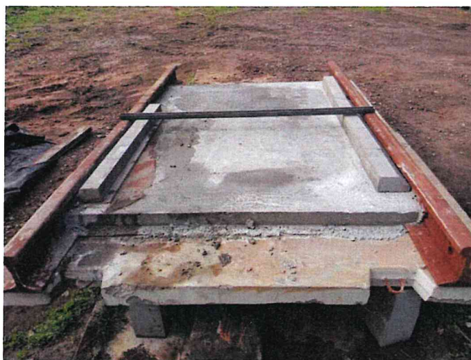
Рис. 1. Фасонный вкладыш фибробетонный В35 (ППФ-40)
