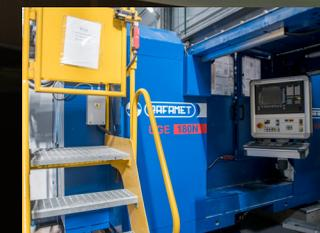
Один из путей – зона ежедневного осмотра – оборудован уникальным для трамвайной отрасли подрельсовым колесотокарным станком для обточки колесных пар без подъема трамвайного вагона.
